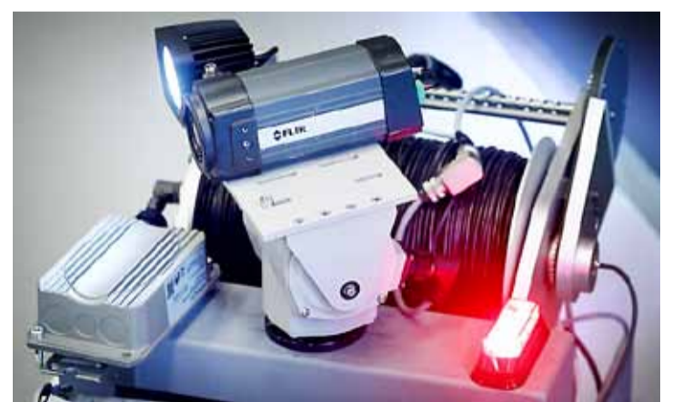
Roboten kan ta sig upp och ner för trappor och skicka ut bilder till räddningstjänsten. Det finns även tankar om att koppla på griparmar så att den ska kunna forsla bort till exempel gasflaskor från en brand.
